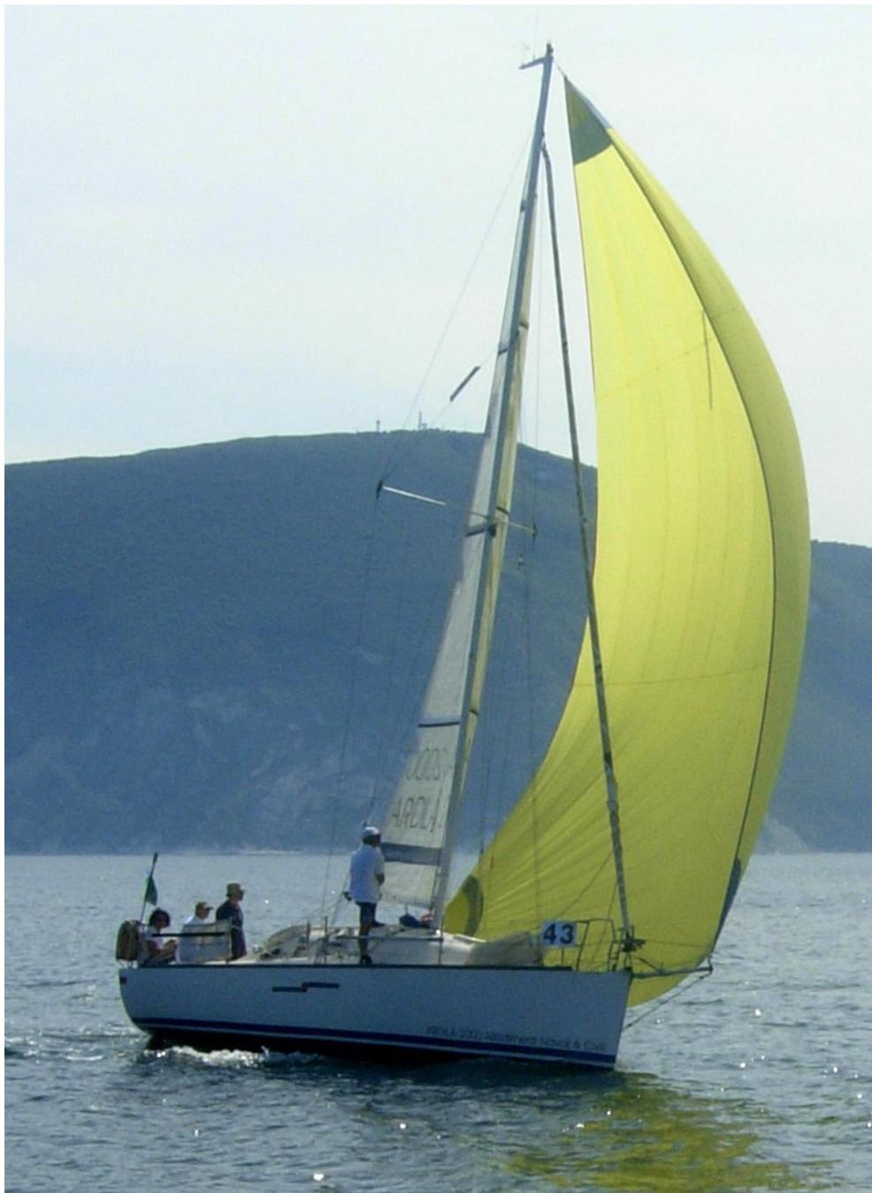
L'attrezzatura e' a 10/11, con crocette acquartierate di 25 gradi sartiamate in spiroidale e lande a murata. L'armo è a cutter con strallo di trinchetta mobile in tessile. La struttura è autoportante anche senza paterazzo e volanti, che sono presenti (non strutturali) per la regolazione dell'albero e la rigidità dello strallo nelle andature di bolina con Code0 e al lasco con spi asimmetrico.
