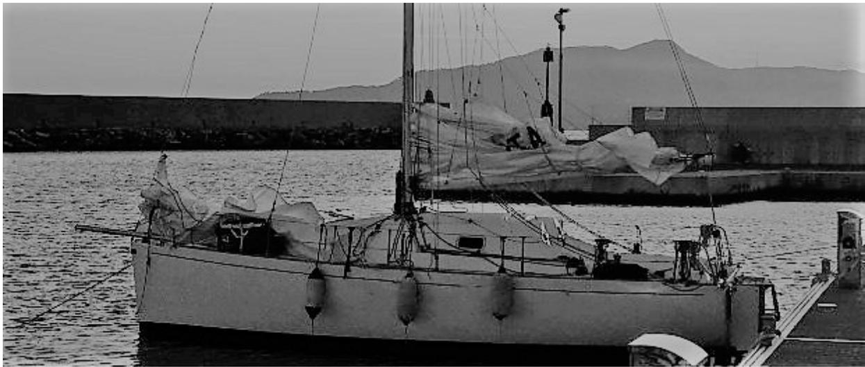
MiniMo770 OC è un moderno monoscafo concepito per la crociera d'altura mediterranea e oceanica. Le linee d'acqua sono concepite per marinità, equilibrio e velocità. Bordo libero e tuga hanno un dimensioni importanti per dare sicurezza ed altezza interna alla parte vivibile. E' offerto con chiglia fissa o lifting, entrambe dotate di bulbo.
